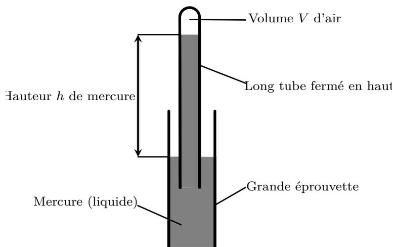
Dans cette manipulation, on peut déplacer le long tube plongé dans le mercure vers le haut ou vers le bas. On peut alors mesurer la hauteur  $h$  de la colonne de mercure et le volume  $V$  de l'air emprisonné au dessus.
