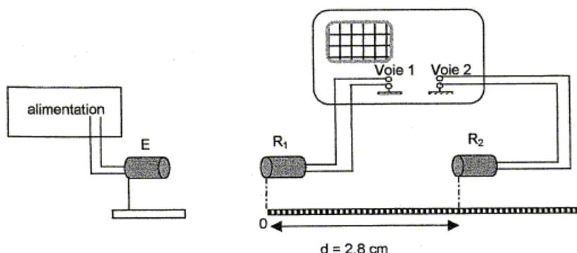
L'émetteur  $E$  génère une onde ultrasonore progressive sinusoïdale qui se propage dans l'air jusqu'aux récepteurs  $R_1$  et  $R_2$ . L'émetteur et les deux récepteurs sont alignés comme représenté ci-dessus.
