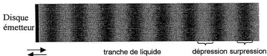
Lors du passage de l'onde dans une «tranche» de liquide, le phénomène de cavitation se produit si la puissance de l'onde est suffisante : des micro-bulles dont le diamètre peut atteindre  $100 \mu\text{m}$  apparaissent. Les micro-bulles sont transitoires. Elles implosent en moins d'une microseconde. Les ondes de choc émises par l'implosion nettoient la surface d'un solide plongé dans le liquide.
