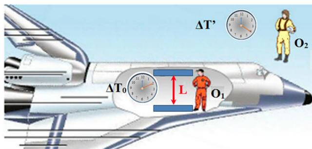
Dans un vaisseau spatial, un observateur  $O_1$ , immobile par rapport à l'horloge de lumière, mesure la durée  $\Delta T_0$  d'un aller-retour de la lumière entre les deux miroirs distants d'une longueur  $L$ . La lumière se déplace à une vitesse de valeur  $c$ .
