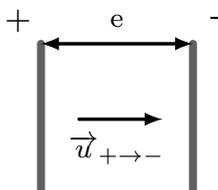
Ainsi, une particule chargée négativement, initialement au repos, comme l'électron présenté ici, se dirigera de la plaque au potentiel le plus faible vers la plaque au potentiel le plus élevé. Calculons maintenant l'intensité de la force  $\vec{F}_e$  que subit cet électron :
